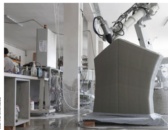
3-D-Druck von Fertigteilen mittels Roboterarm für die Brücke „Striatus“ in Venedig
