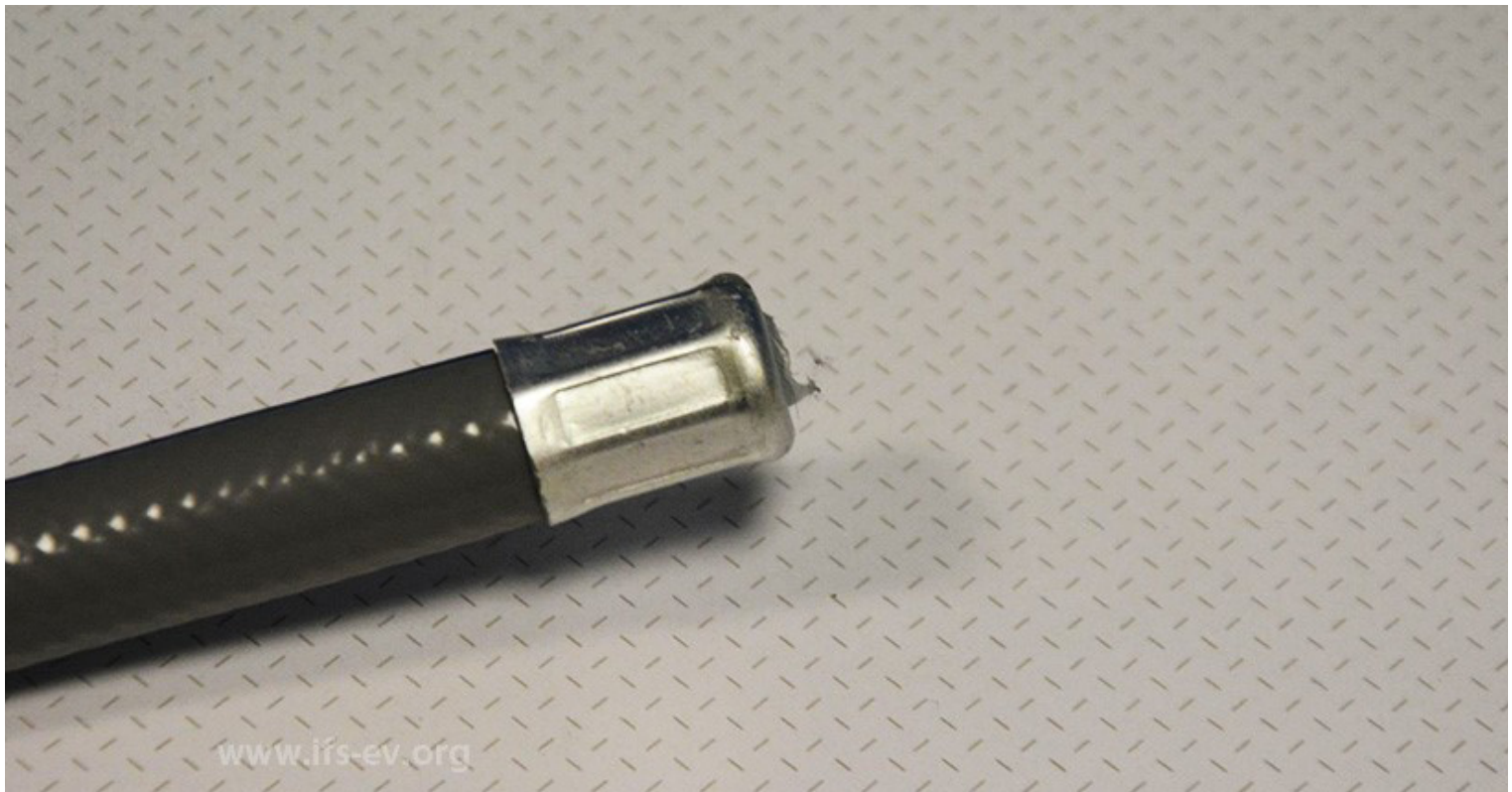
Der Zulaufschlauch ist abgerissen. Foto: www.ifs-ev.org .
