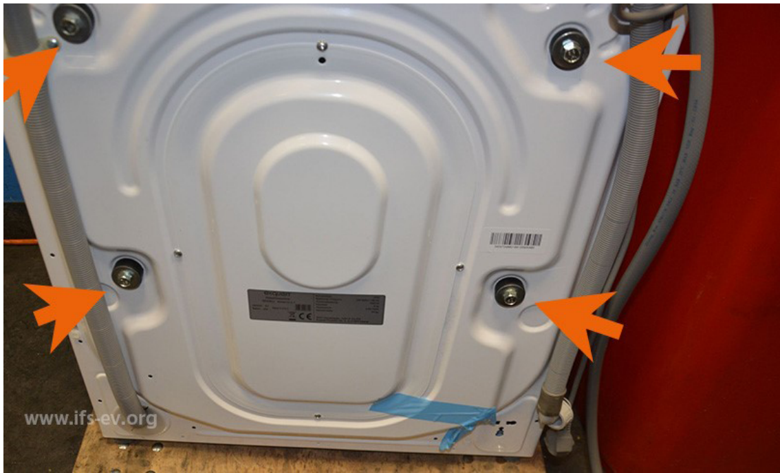
An der Rückseite sind die Transportsicherungen noch montiert. Foto: www.ifs-ev.org .
