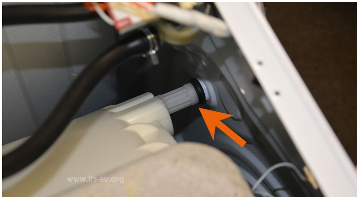
Die Sicherungen (Pfeil) verbinden die Trommel mit dem Gehäuse. Foto: www.ifs-ev.org .
