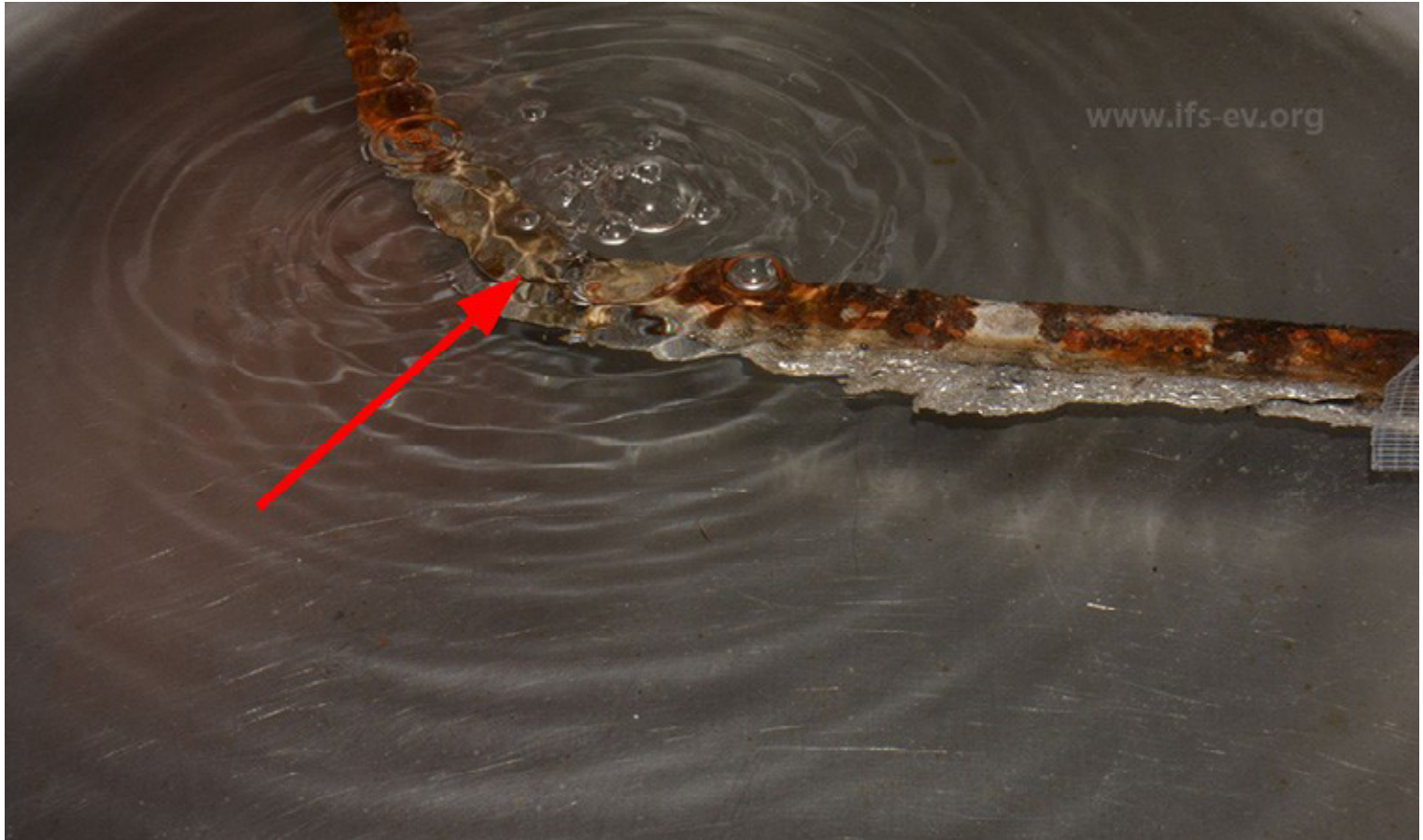
Ein korrodiertes Heizungsrohr wird im Labor auf Dichtigkeit geprüft. Foto: www.ifs-ev.org .
