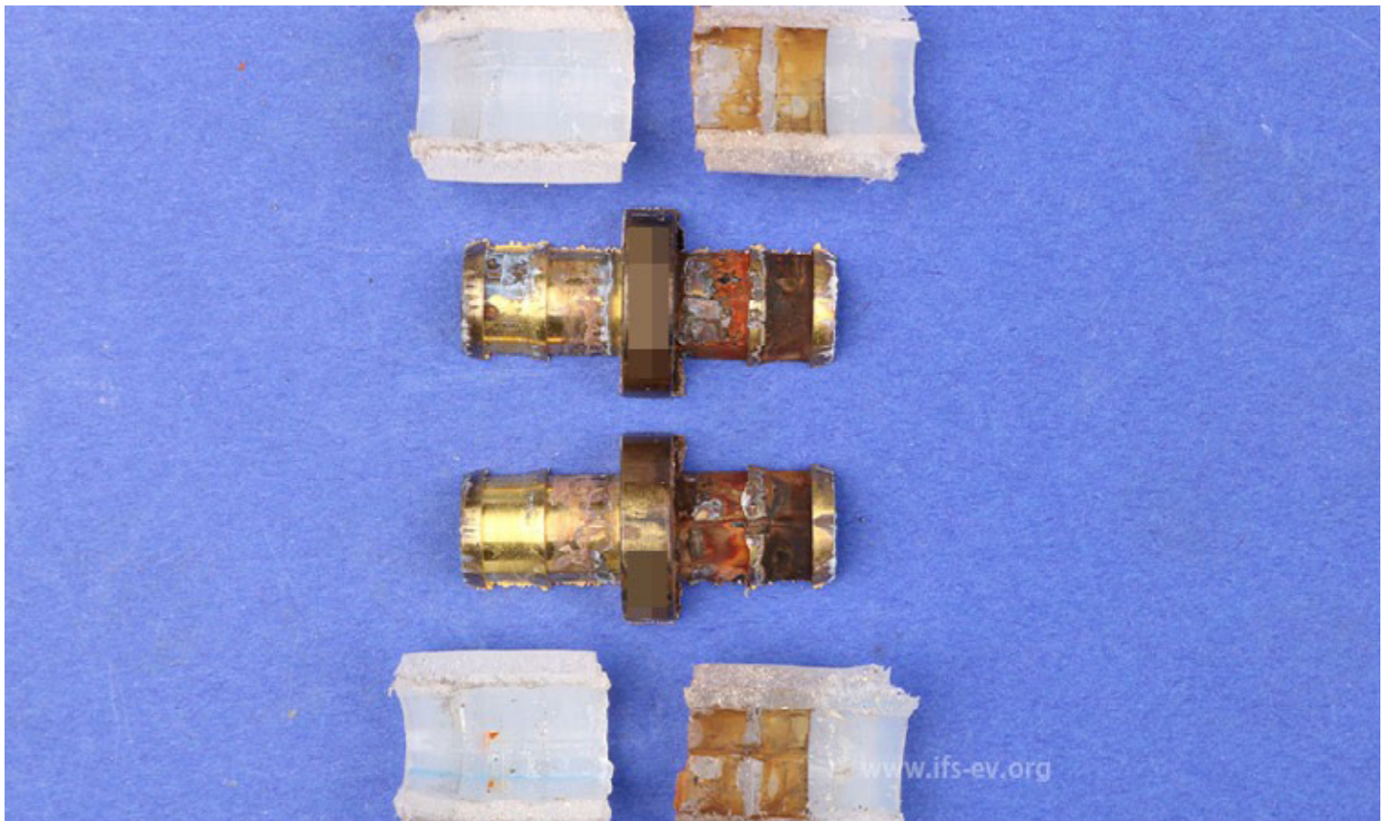
Das aufgetrennte Fitting: Links die dichte Verbindung, rechts die undichte. Foto: www.ifs-ev.org .
