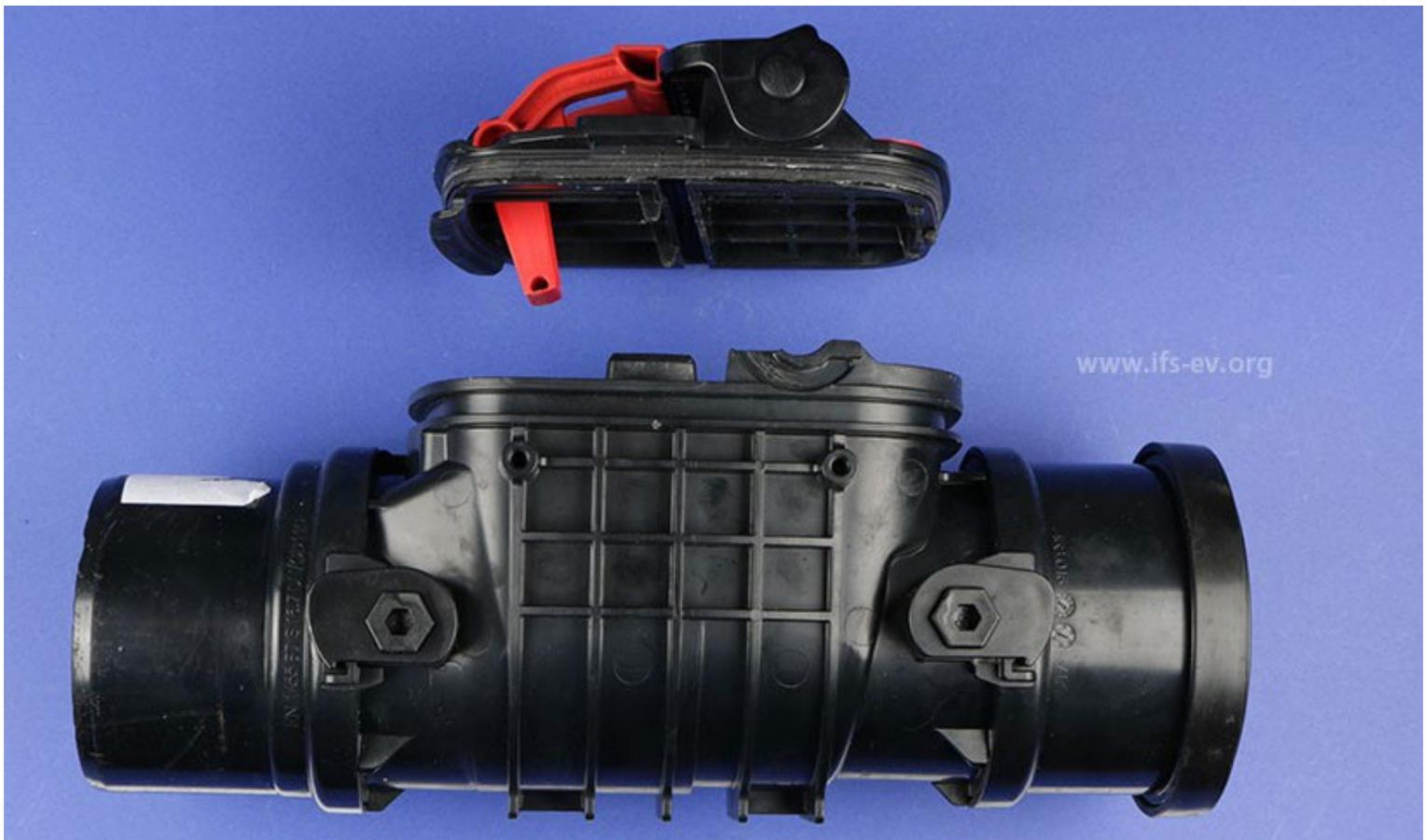
Die Rückstausicherung aus dem zweiten unten geschilderten Fall besteht aus einem Grundkörper mit zwei eingesetzten Klappen und einem Deckel mit Notverschluss-Hebel (rot). Foto: [www.ifs-ev.org](http://www.ifs-ev.org).
