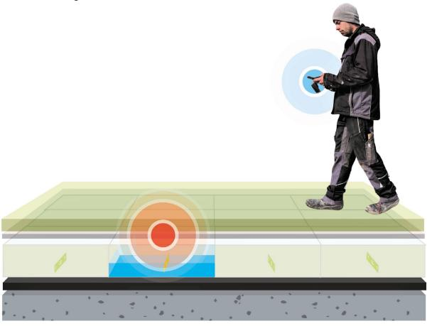
Kontrolliert werden die Nässe-Sensoren mit einem Scan-Gerät und dem Smartphone. Die HUM-ID App für iOS und Android ermöglicht eine schnelle und intuitive Kontrolle und protokolliert nasse Stellen automatisch. Alle erfassten Daten stehen den Anwender jederzeit zur Verfügung.
