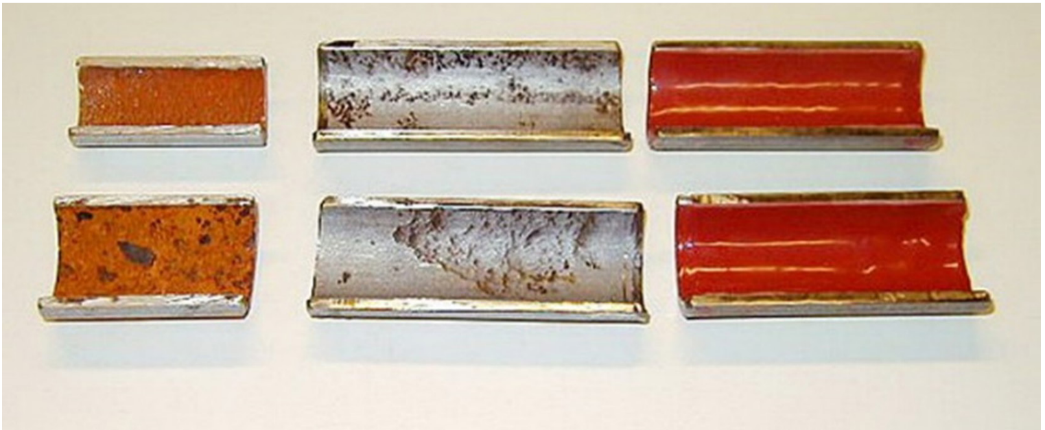
Bild 1: Verfahrensschritte der Epoxidharz-Beschichtung mit 1. Reinigung der Korrosionsprodukte, bis die blanke Metalloberfläche zutage tritt und 2. dann die Beschichtung
