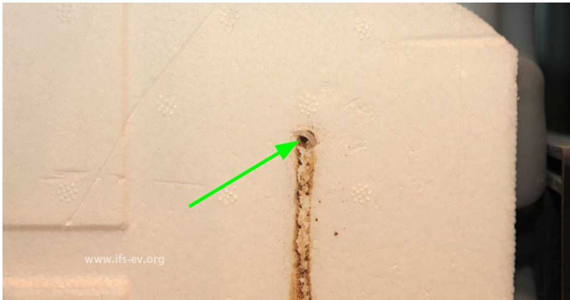
Die Ablaufspuren entspringen einem kleinen Loch. Foto: www.ifs-ev.org .
