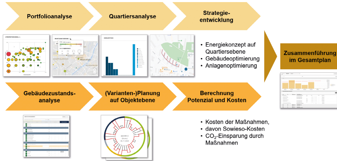
Abb. 2: Bei der Erstellung eines energetischen Sanierungsfahrplans sollten sowohl die Objekt- als auch die Portfolioebene betrachtet werden. Quelle: CalCon Deutschland GmbH
