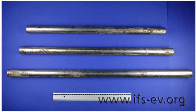
Korrosionsspuren und Ablagerungen von Wasserinhaltsstoffen an den Stahlrohren. www.ifs-ev.org.
