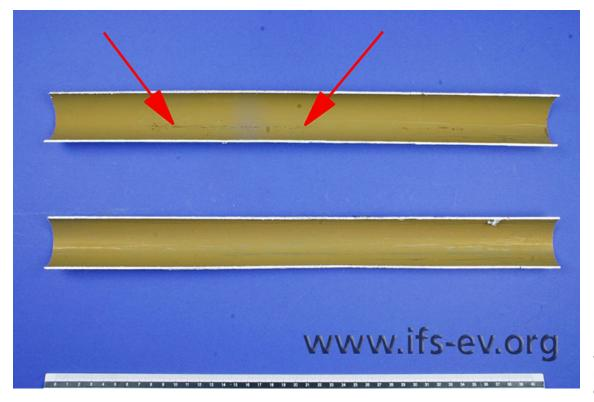
Die Rohrinnenwand ist gleichmäßig mit einer Deckschicht belegt, und im Rissbereich (Pfeile) gibt es keine Korrosion. www.ifs-ev.org.
