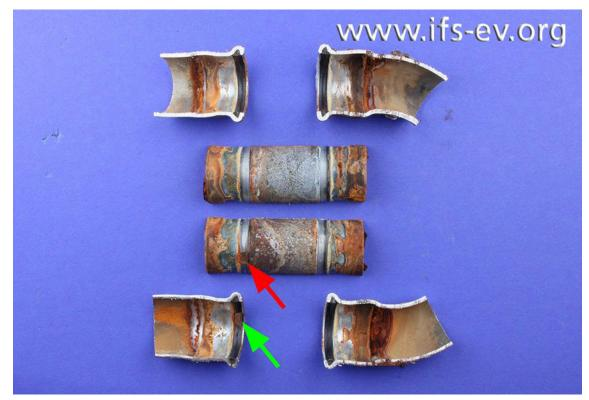
Das Rohrstück und die Pressverbindungen werden aufgetrennt. Dabei fällt eine runde, bräunliche Verfärbung auf (Pfeile). www.ifs-ev.org.
