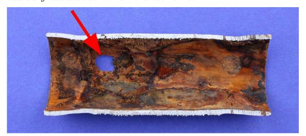
An dieser Stelle befindet sich ein Wanddurchbruch mit einem Durchmesser von etwa 6 mm. www.ifs-ev.org.
