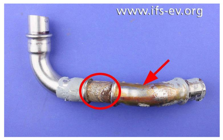
Zwei Bögen und ein kurzes Rohrstück, durch Pressverbindungen miteinander verbunden. Ist das die Leckagestelle? www.ifs-ev.org.
