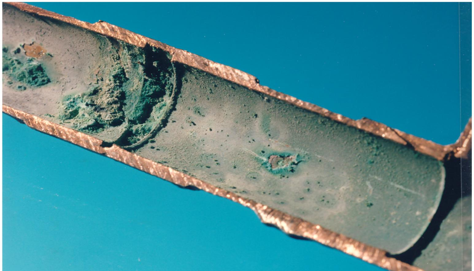
**Bild 2:** Kupferrohr mit Korrosionsangriffen an den nicht entgrateten Stellen durch die Ausbildung von sogenannten Belüftungselementen. Die homogene Deckschicht fehlt. Bildquelle: Christoph Gies, Dinslaken
