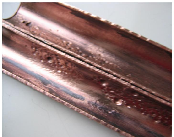
**Bild 4 und 5:** Lochkorrosion in horizontal verlegte Leitungen, die zumindest zeitweise nur zum Teil mit Wasser gefüllt waren. Nach Entfernung der Korrosionsprodukte zeigt sich der zu erwartende, lochförmige Angriff des Grundwerkstoffs. Bildquelle: Christoph Gies, Dinslaken
