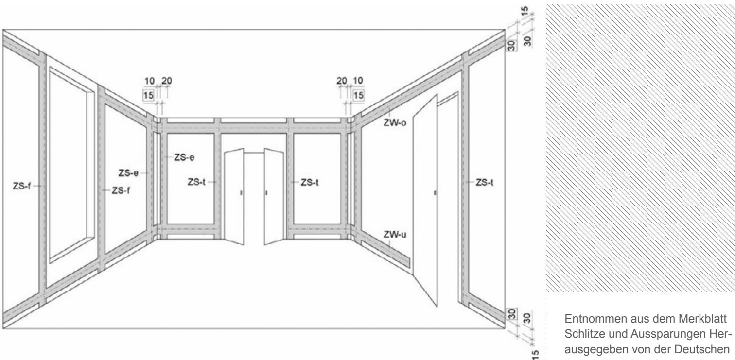
**Bild 1:** Installationszonen und Vorzugsmaße (im Kasten) für Elektroinstallationen in Räumen (DIN 18015-3). Gilt nicht für Räume mit Arbeitsflächen an Wänden z. B. Küchen.
