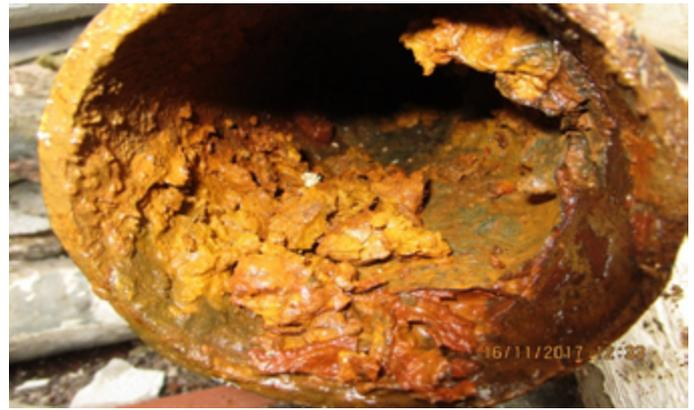
Beispiel für die Bildung eines Biofilms in den Versorgungsleitungen.
