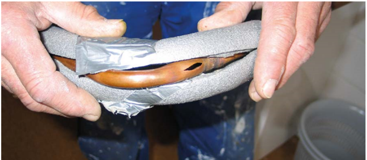
Das geplatzte Kupferrohr befand sich in einer unbeheizten Abseite. Quelle: www.ifs-ev.org
