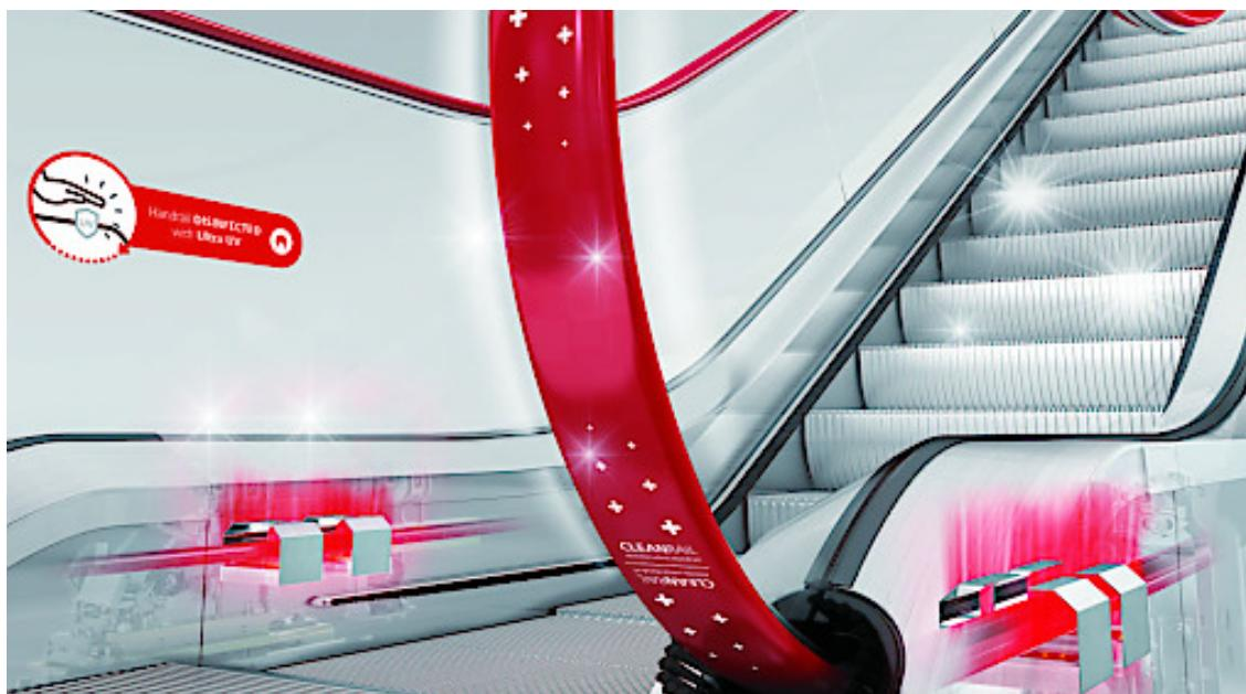
Im unsichtbaren Bereich werden die Handläufe mit UV-C-Licht bestrahlt. Foto: Schindler
