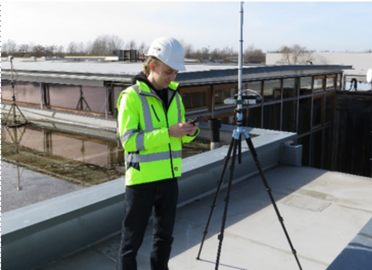
Mittels 360-Grad-Kameratechnik werden auch großflächige Dächer effizient erfasst. Foto: Solutiance
