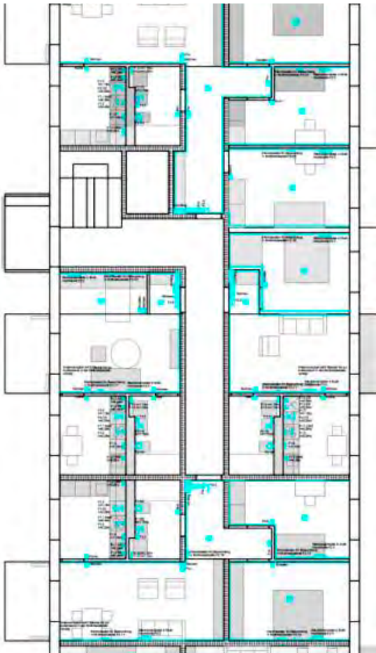
Einsatz einer offenen, ansprechend gestalteten Medienleiste vor der Wand für Elektroinstallation und Medienversorgung.
