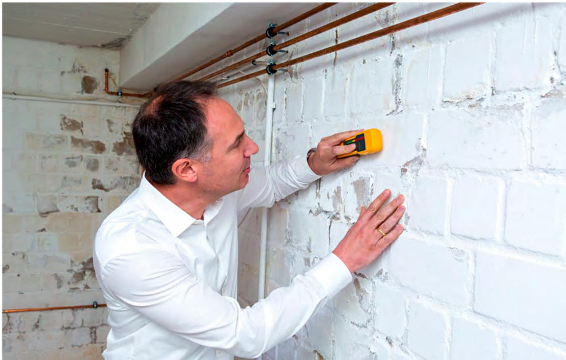
Durch Feuchtigkeit in den Wänden bilden sich Salzkristalle. Sie sprengen Farben und Putze von den Wänden und greifen auch den Fugenmörtel zwischen den Steinen an. Hier ein Experte bei der Feuchtemessung; Foto ISOTEC
