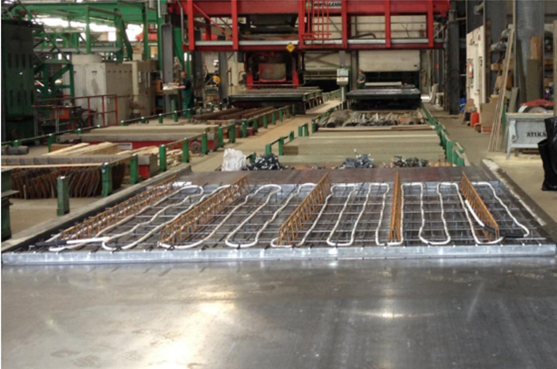
Nach dem Verlegeplan von Uponor wurden die thermisch aktivierten Deckenelemente mit Rohrregistern bestückt.
