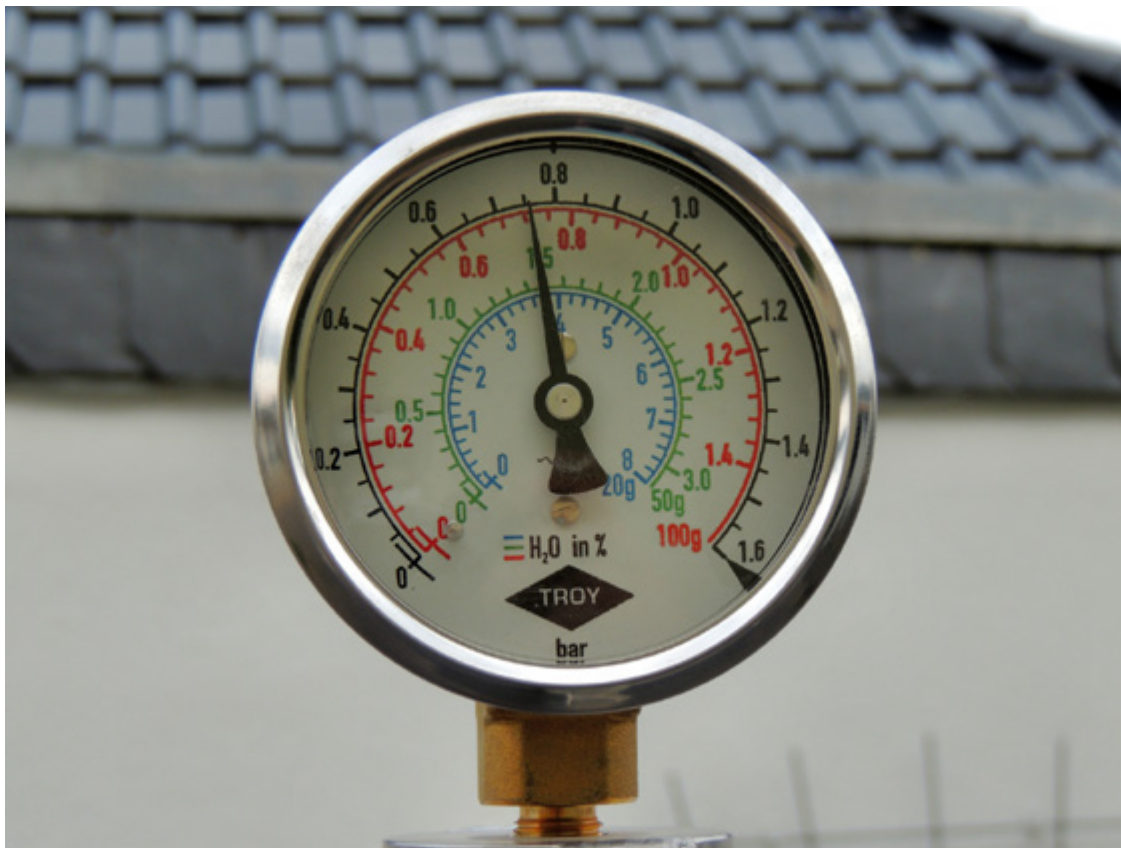
Messung des Feuchtegehaltes; Foto MC
