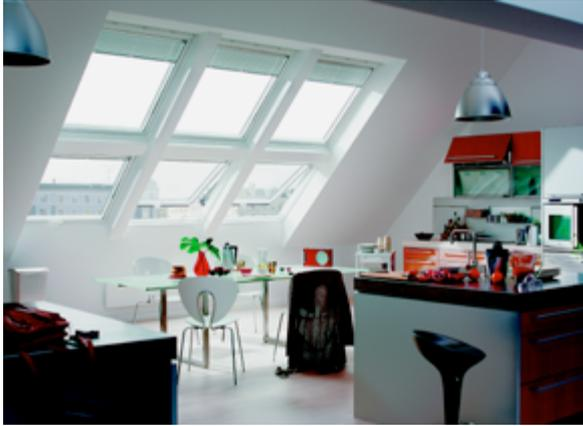
Die fachgerechte Anordnung von Fenstern sowie die Anzahl der Wohndachfenster oder Gauben entscheiden über die sachgemäße Ausleuchtung der Wohnräume mit Tageslicht. In Anhängigkeit von der Grundfläche eines Raumes sowie dem gewünschten Wohnkomfort wird die Gesamtgröße der verglasten Öffnungsflächen ermittelt. In den meisten Landesbauordnungen wird eine Mindestlichtfläche von 10 Pro-
