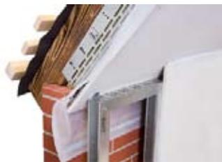
In die kürzeren Winkelteile wird dann das notwendige Dämmstoffpaket eingebracht und mit einer Langlochzunge gegen das Abrutschen gesichert. Das Profilsystem lässt sich auch zur Drempeausbildung einsetzen.
